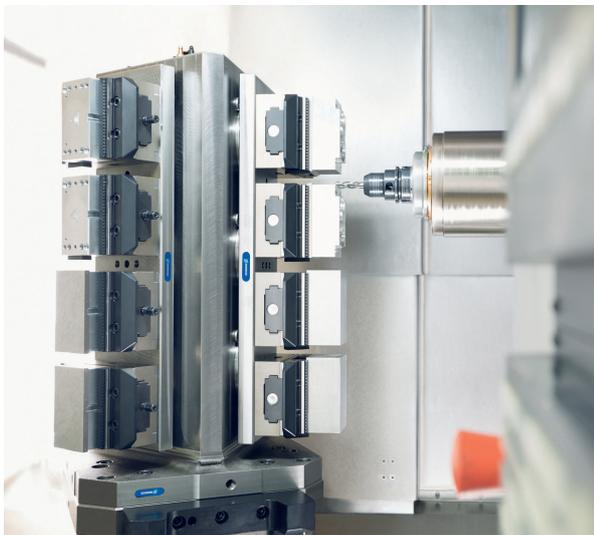
5 Die High-End-Automatisierung: Flexible Fertigungssysteme (FMS) bilden die komplette Fertigung ab. Spanntürme sowie das vielseitige Portfolio an Spannwerkzeugen sind Bestandteile einer Komplettlösung, die Materialflüsse optimiert sowie Fertigungsschritte flexibilisiert © Schunk
