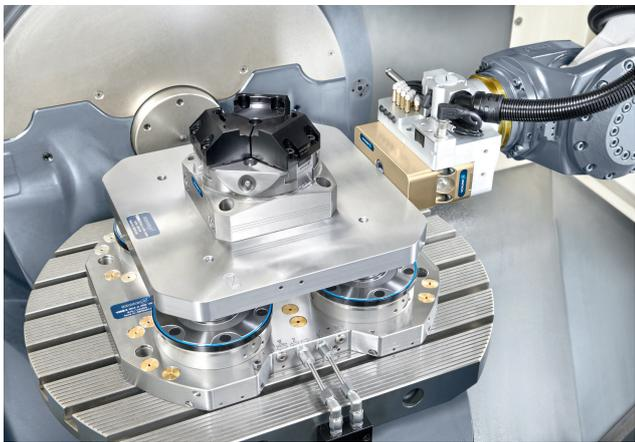
**3** Für das Spannen von schweren und komplexen Werkstücken sowie bei hohen Anforderungen an die Spanngenauigkeit ist das Automatisierungskonzept 'Paletten-Automation' die richtige Wahl © Schunk
